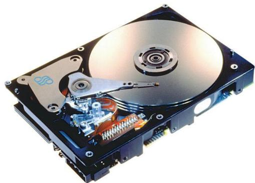
jede Plattenoberfläche ist ein eigener Schreib-/Lese-Kopf vorgesehen. Die Köpfe werden von einem gemeinsamen Antriebsmechanismus bewegt und fliegen ähnlich einem Luftkissenfahrzeug über die Plattenoberfläche.
